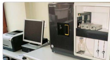
Spektrometr masowy typu pułapka jonowa ze źródłem jonizacji ESI-HCTultra firmy Bruker, z zestawem pomp próżniowych oraz pompą strzykawkową, Bruker (Pracownia proteomiki i transkryptomiki)
